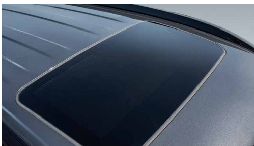
Techo solar con apertura eléctrica. (1)
