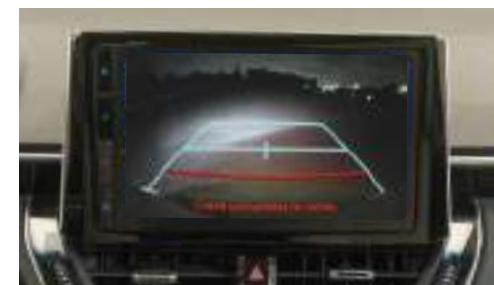
Monitor con cámara de estacionamiento.
