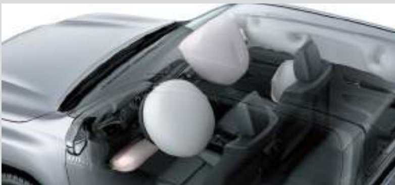
7 airbags: frontales (x2), de rodilla (conductor), laterales (x2) y de cortina (x2)
