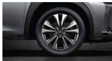
LLANTAS DE ALEACIÓN CON NEUMÁTICOS 225/50 R18 RUN FLAT
