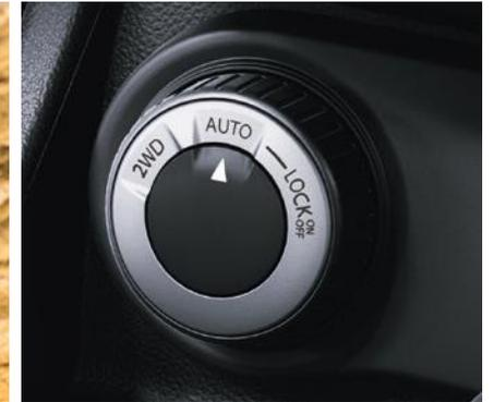
**Modo 2WD:** el vehículo opera como un 4x2 básico donde traccionan únicamente las ruedas frontales, sin ningún límite de velocidad.
