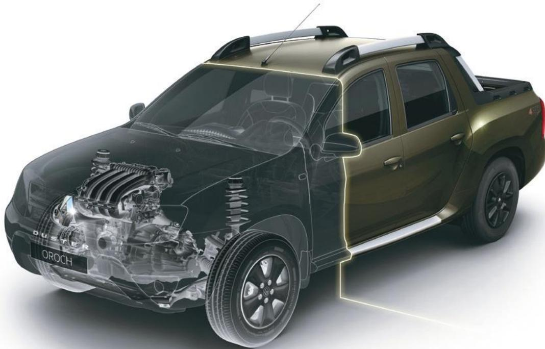
La suspensión trasera Multilink combinada con la distancia entre ejes te permitirán un mayor control en la conducción, menor nivel de ruido y una excelente estabilidad independientemente del terreno. Y la suspensión delantera independiente, tipo Mc Pherson con resortes helicoidales y barra estabilizadora, está calibrada para garantizar estabilidad en las curvas y confort en el andar.
